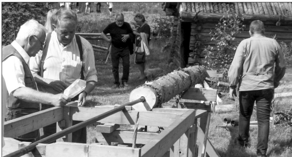
Finnetunet 13. juli 2019. Boret er plassert i glidelagrene og boringen så vidt i gang. Bukkens høyre vange vises i full lengde. Fremre labank (fastmontert mellom vangene) befinner seg nærmest stokken. Bakre labank (skyobar oppå vangene) befinner seg foran personen som borer (utenfor bildet). Stokken, med avstandsmarkøren synlig i fjerne enden, er godt surret fast. (Foto Geirmund Skeie).
