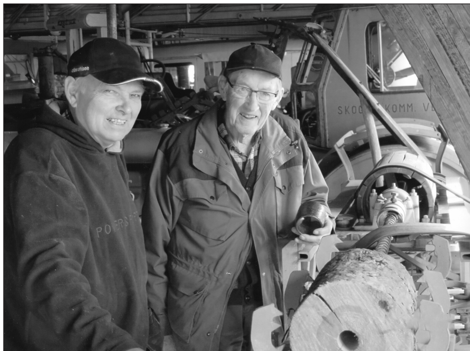
Ole Bækkedal (t.v.) i samtale med Halvard Brynjulvsrud på Motorhistorisk museum i Stange i mai 2021. De studerer en boremaskin for stokkrør. Bækkedal forteller at da det ble lagt nye vannledninger i Hamar på 1980- og 1990-tallet, var det gamle stokkrør som ble erstattet. De hadde da fungert i over hundre år. (Foto: Øyvind Krogsrud)
