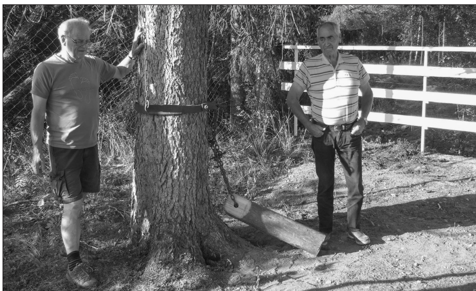
Lenseutløseren ved Løsetdammen. En lensestokk (tømmerstokk) er festet til utløseren. Olav Verket t.h. har laget arrangementet. T. v. Henrik Tronbøl.
